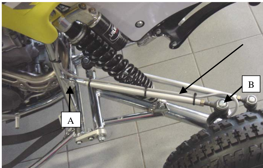
Fig 1: Op de figuur is de trekstang aangegeven.
